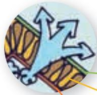
L'ouverture à la vapeur d'eau des matériaux d'une paroi perspirante est de plus en plus grande de l'intérieur vers l'extérieur.
